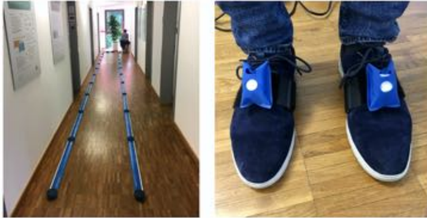
Abbildung: Aufstellung der Gangdatenaufzeichnung zur Bewertung des IMU-Ganganalysealgorithmus. Links: der 10 m lange OptoGait-Gang. Das OptoGait-System (Microgait, Italien) wurde als Goldstandard zur Kreuzvalidierung der aus IMU-Daten berechneten Gangparameter verwendet. Rechts: Die IMUs wurden oben auf den Schuhen befestigt, um Gangdaten aufzuzeichnen.
